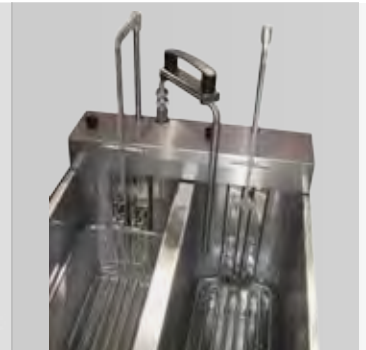
Elevador de cestas y bomba filtraje
