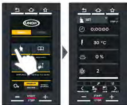
**08** ▶ Si, al encenderse el equipo, aparece la pantalla de la modalidad SPEED (cocciones rápidas), significa que ha sido la última modalidad utilizada antes del apagado del equipo.
