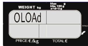
Este mensaje indica que el peso depositado en el plato de la báscula ha excedido la capacidad máxima. Para corregirlo, simplemente retire el exceso de peso.
