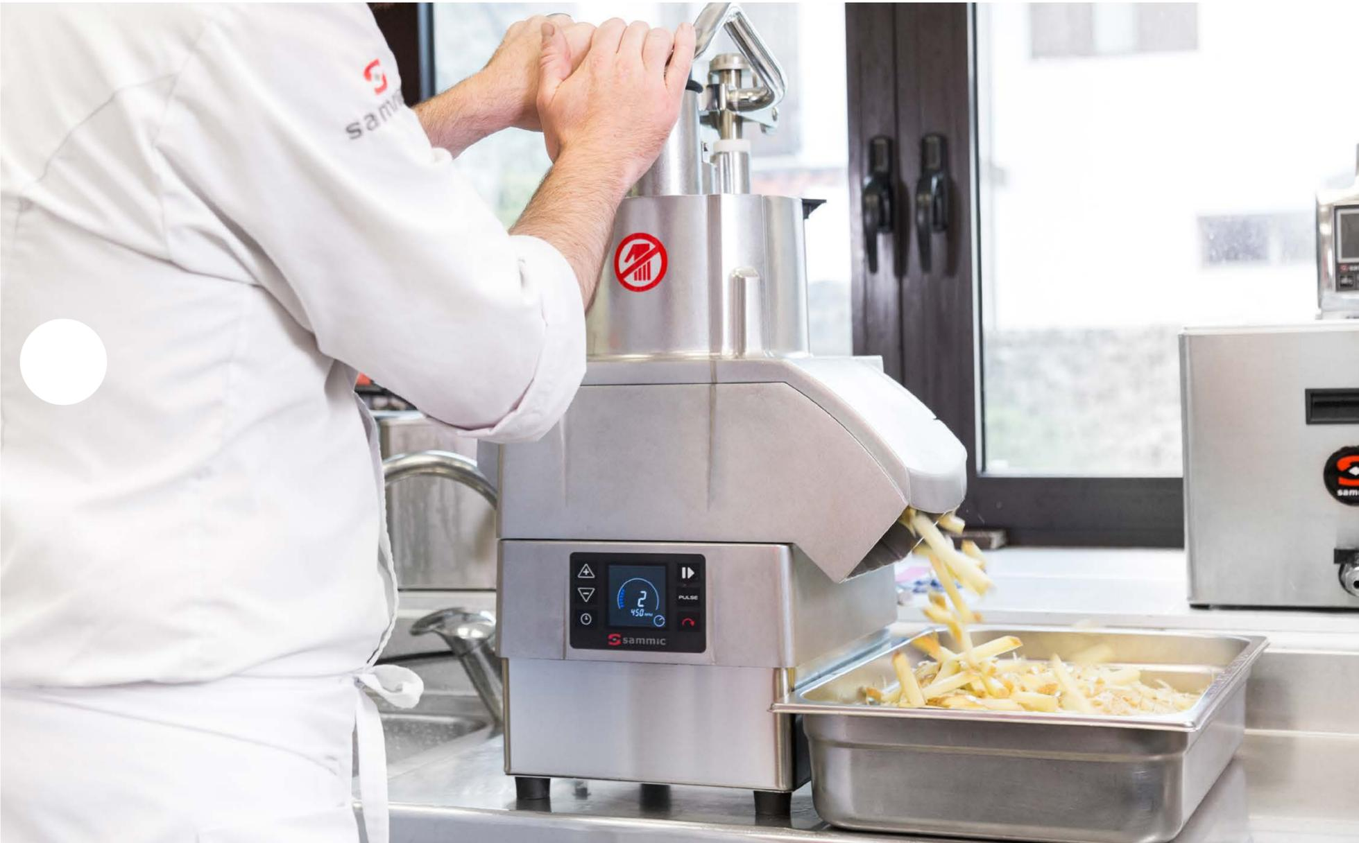
Como la salida del producto se produce por un lateral, las cortadoras **requieren menos fondo en la mesa de trabajo** y se consigue un flujo de trabajo óptimo en la zona de preparación.
