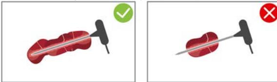
1. Inserte la sonda térmica en el mayor número posible de trozos de alimentos hasta que esté cubierta con alimentos desde el mango hasta la punta.
