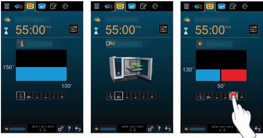
Si se ha iniciado una ruta de cocción inteligente, la pantalla cambia al Cockpit después de un corto tiempo. Aquí se muestran todos los pasos de cocción que realiza la ruta de cocción inteligente uno tras otro. El paso de cocción activo aparece marcado. Los pasos de cocción posteriores, se muestran en gris. Cuando un paso de cocción ha terminado, el siguiente paso de cocción se muestra automáticamente.
