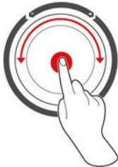
En lugar de Gestos [► 25], los ajustes pueden modificarse girando la perilla central de ajuste. Confirme las acciones oprimiendo la perilla central de ajuste.
