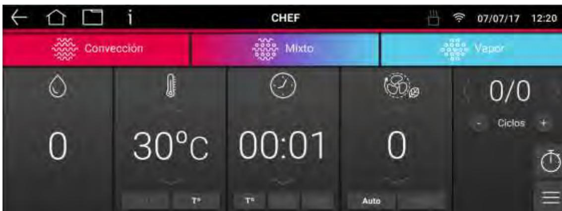
En los programas de usuario es posible modificar cualquier parámetro de cocción (temperatura, humedad, tiempo, modo de cocción, etc.). Para hacerlo, debe seleccionar el botón correspondiente al parámetro a modificar y ajustar el valor del parámetro.
