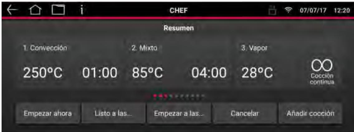
Esta pantalla muestra un resumen de los ciclos de cocción programados, y permite visualizar y navegar entre ellos para ver en detalle los parámetros. Cada vez que un ciclo finaliza o se pasa automáticamente al sucesivo, se emite una señal acústica.
