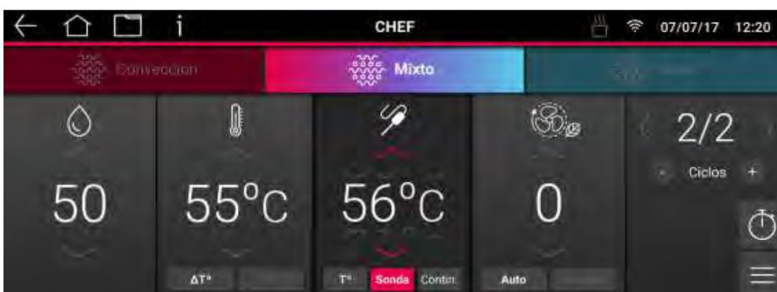
Si no estuviera la sonda conectada, el horno lo indicará mediante el mensaje que se muestra y mediante señal acústica. En tal caso, conecte la sonda y pulse OK.
