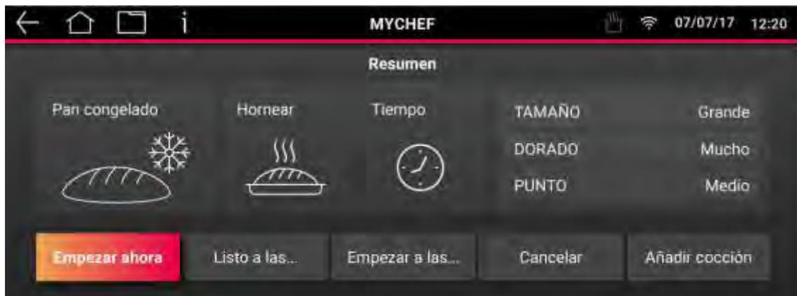
Si se desea dar inicio a la cocción, al seleccionar "Empezar ahora", la cocción iniciará, el indicador LED se iluminará y el indicador de cocción en el encabezado se activará.
