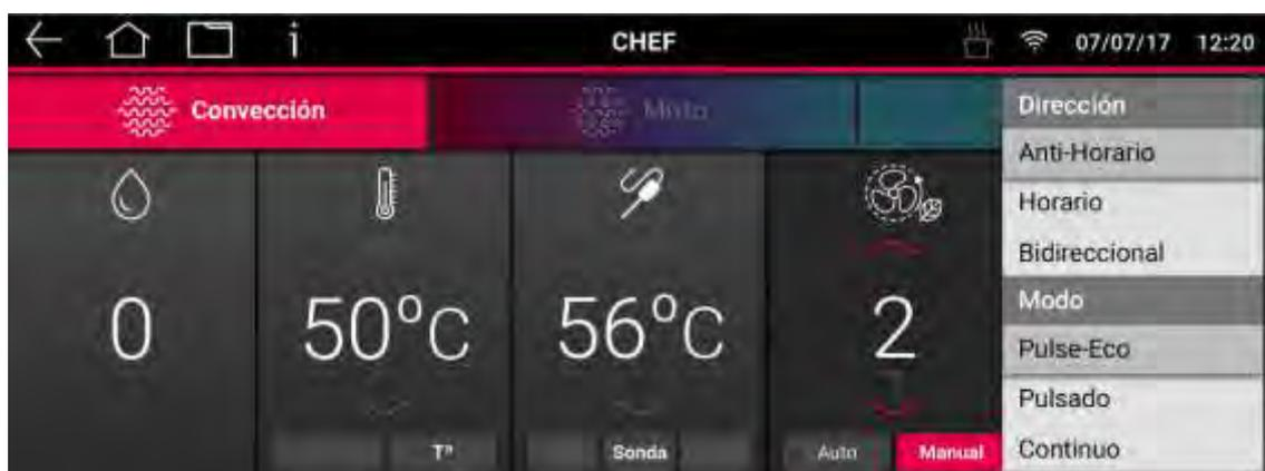
**Modo Auto:** La velocidad del ventilador se ajustará de modo automático en función del tipo de cocción que se esté realizando, optimizando el resultado de la cocción.
