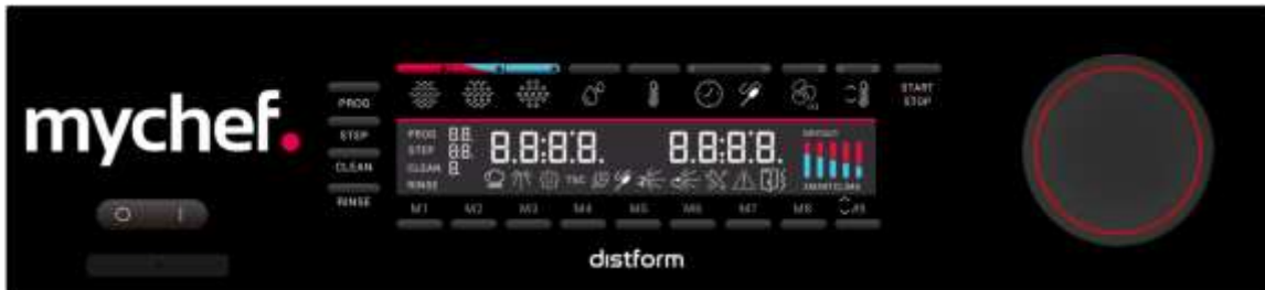
Figura 1. Panel de control.
