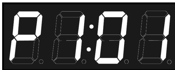
Figura 17: Ejemplo. Visualización del parámetro P1 y su valor (01)
