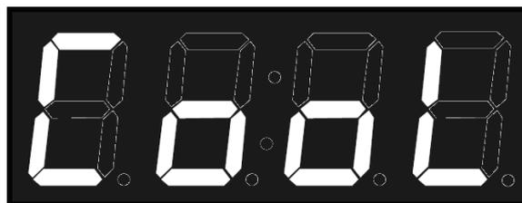
**Figura 19. Ajuste de temperatura necesario**
