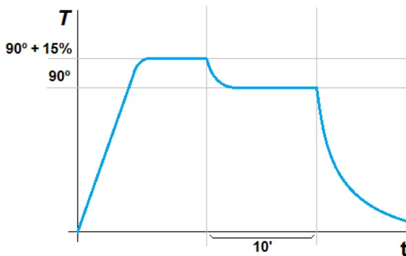
Figura 14. Temperatura horno
