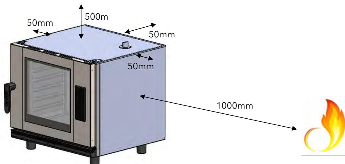
**Figura 2. Ejemplo de emplazamiento adecuado para instalación**
