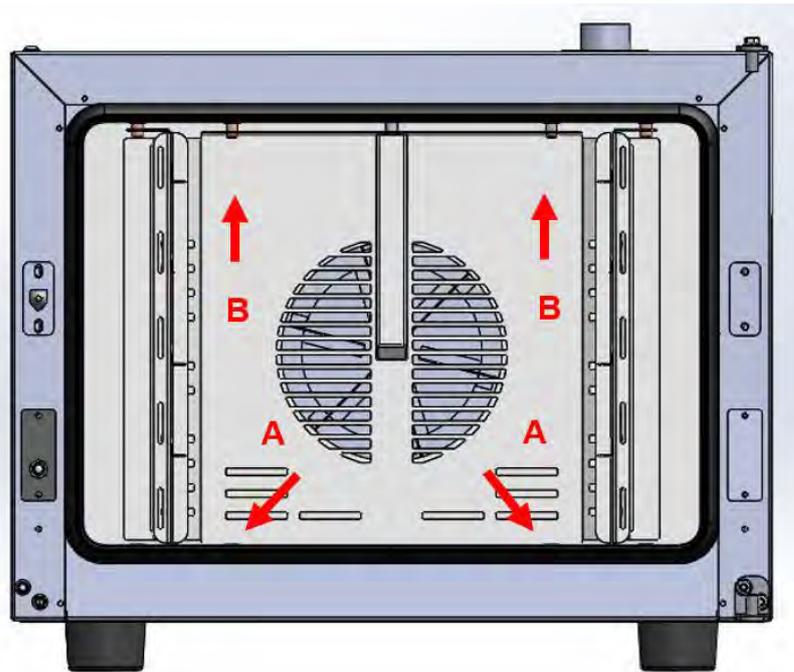
**Figura 41. Tornillos de fijación de la chapa de aspiración**
