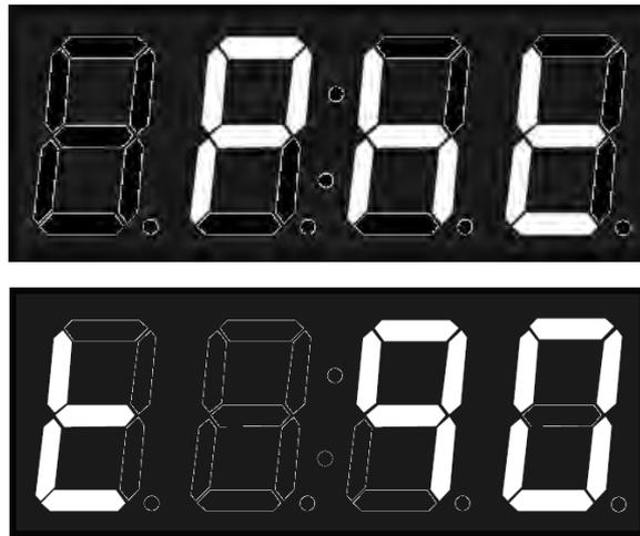
**Figura 8. Indicador de precalentamiento**
