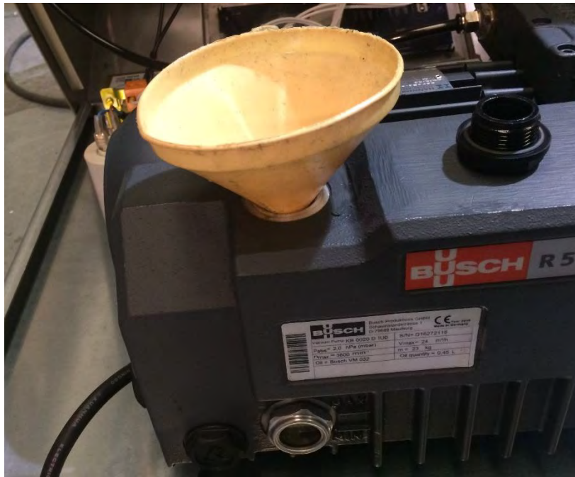
Ilustración 7. Quitar el tapón de llenado de aceite y rellenamos con aceite nuevo
