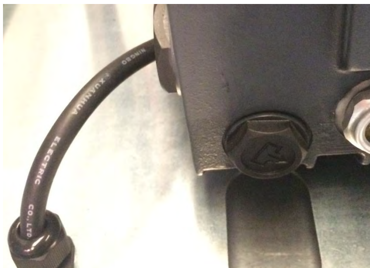
Ilustración 5. Quitar el tapón de vaciado del aceite
