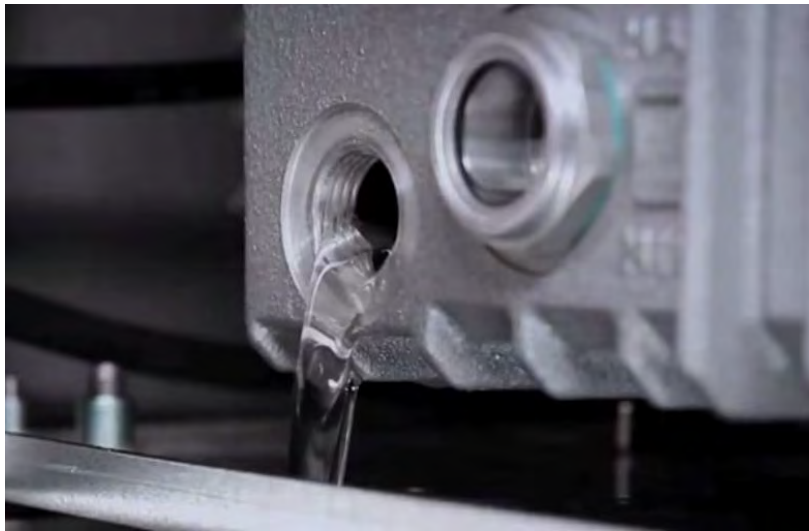
Ilustración 6. Drenaje del aceite
