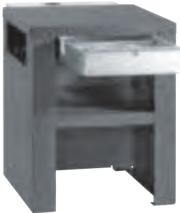
APCL 089 Zócalo abierto con caja de filtro de pelusas, 75 cm de altura, para filtrar las pelusas y las partículas gruesas del agua de lavado. • Al/An/Fo: 75,60 cm – 60,50 cm – 86,00 cm
