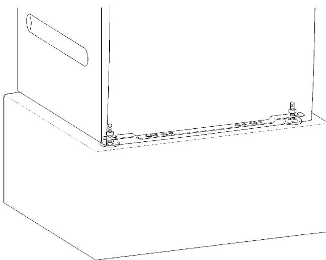
El aparato se fija al suelo a través de las dos bases de apoyo frontales con los estribos de fijación proporcionados. El material de fijación adjunto está diseñado para una fijación con tacos en un suelo de hormigón.
