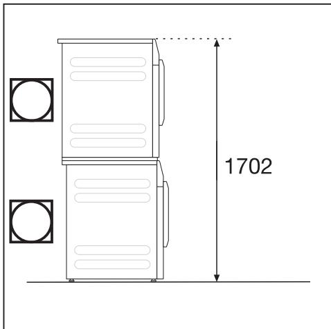
Las 2 secadoras Miele se pueden instalar en forma de columna de secado. Para hacerlo es necesario un juego de unión\*. El montaje debe realizarlo un técnico autorizado de Miele.
