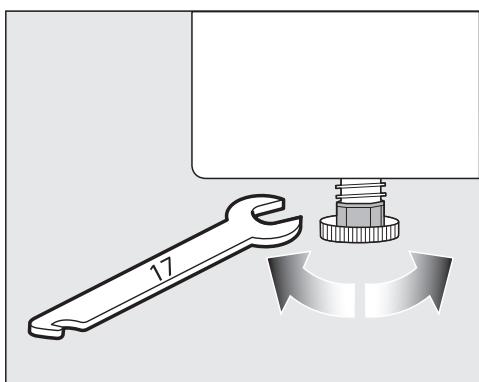
Los desniveles del suelo se pueden compensar ajustando las patas rosadas.
