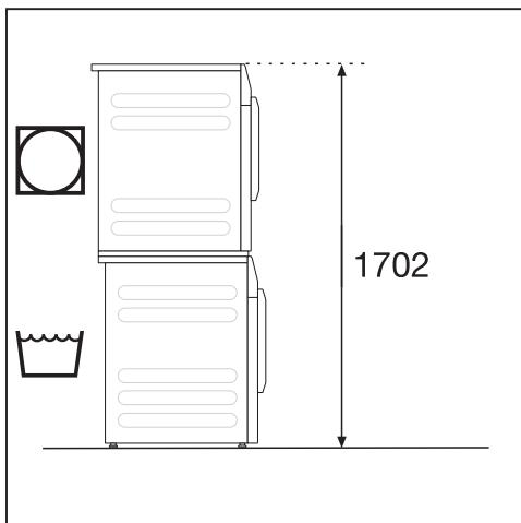
La lavadora se puede instalar como columna lavado-secado con una secadora de Miele. Para ello se requiere un kit de unión (accesorio opcional).
