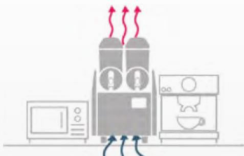
▲ Sistema AIR FLOW de ventilación vertical
