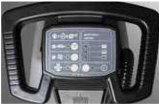
Interruptor de encendido/apagado que evita el encendido accidental. Protección contra sobrecargas, descarga excesiva de la batería (solo modelos con batería) y uso accidental. Práctico mando para desenganche/mantenimiento del cepillo. Ajuste Eco Energy para un uso prolongado y un funcionamiento extremadamente silencioso (solo modelos con batería).
