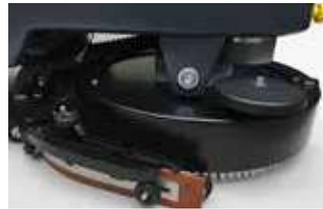
Amplia rotación de la boquilla para una fácil sustitución de la cuchilla y un secado perfecto incluso en las esquinas. Sencilla selección y dispensación automática de la solución detergente para ahorrar productos químicos y adaptarse a las diferentes condiciones del suelo. Alta estabilidad y capacidad para superar pequeños desniveles.
