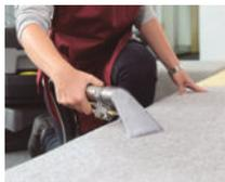
Boquilla manual pulverización y extracción
