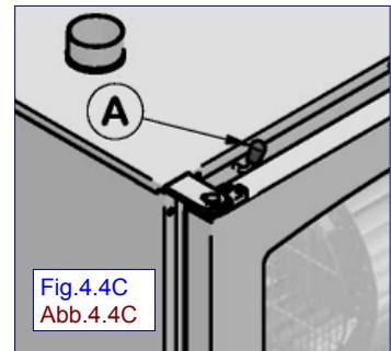
**4.4E Entlüftungsventil des Garraums** (Abb. 4.4C)
