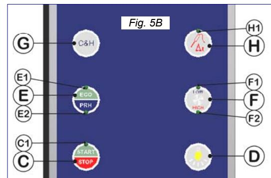
**5.4 ZUSÄTZLICHE STEUER- UND REGELVORRICHTUNGEN**Modelle **ELECTRONIC** (Abb. 5 - 5B)**5.4A Kerntemperaturfühler mit Delta T ( $\Delta t$ )** (Abb. 5B)
