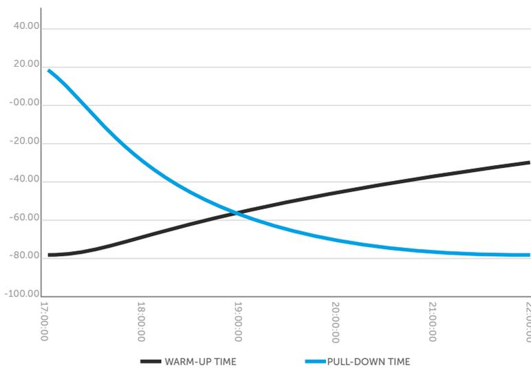
\* Pruebas realizadas con una temperatura ambiente de +25°C y 60% Humedad
