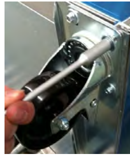
Atornille las ruedas en los mismos agujeros y asegúrese de que se encuentra correctamente nivelado
