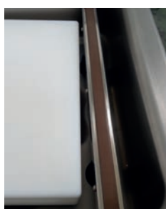
Barra Soldadura BV
