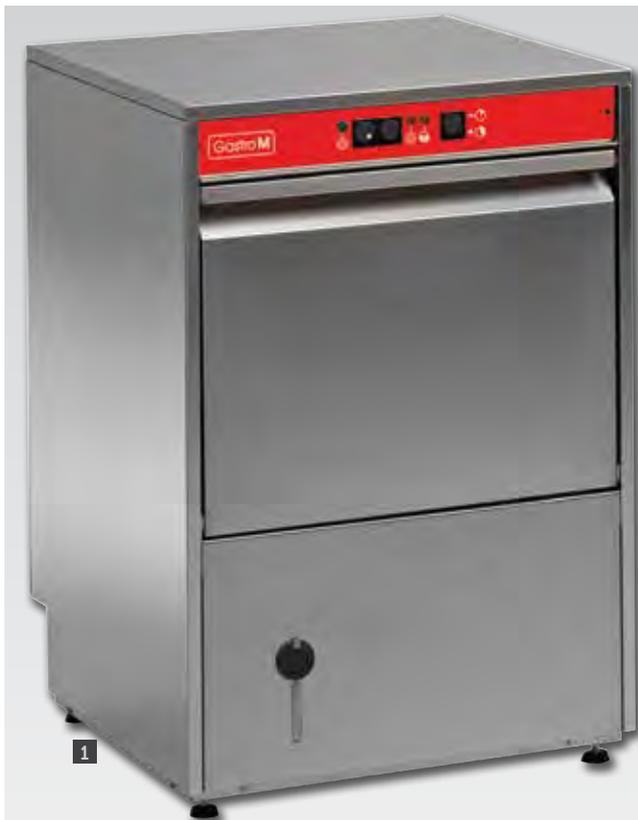
Lavavasos electromecánicos Gastro-M fabricados en acero inoxidable 18/10, puerta de pared doble, 2 programas de lavado, interruptor de conexión e interruptor de programas. Operación totalmente automática. Control de temperatura de la resistencia independiente para lavado y aclarado. Brazos de acero inoxidable de fácil limpieza y micro-interruptor de seguridad en la puerta. Conexión a la red de agua 3/4 pulgadas.
