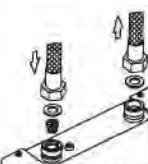
Der Durchlauferhitzer soll mit den nach oben gerichteten Stutzen montiert werden.
