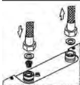
El calentador se puede conectar solamente con las conexiones hacia arriba.
