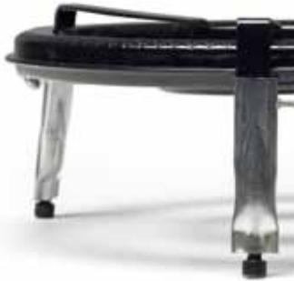
**Butano** El quemador debe conectarse a una botella de gas butano mediante un tubo flexible. Este tubo, que no debe estar caducado, irá ajustado con abrazaderas al quemador en un extremo y en el otro al regulador de 30 mbar que va acoplado a la botella.
