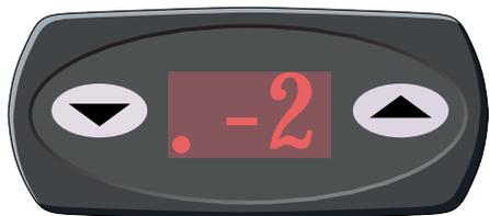
Si el decimal point visualizado está a la izquierda, la temperatura indicada se refiere al depósito 1.
