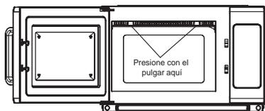
1. En el bloqueo de aceite presione la flecha que se muestra, empuje hacia atrás con fuerza y luego tire hacia abajo.
