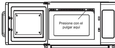
2. Sujete el microondas con la mano izquierda, use el pulgar derecho para presionar las direcciones de las flechas y presione para empujar hacia atrás. Presione con el pulgar izquierdo hacia arriba al mismo tiempo. Coloque el bloqueo de aceite correcto en la hebilla del panel frontal.
