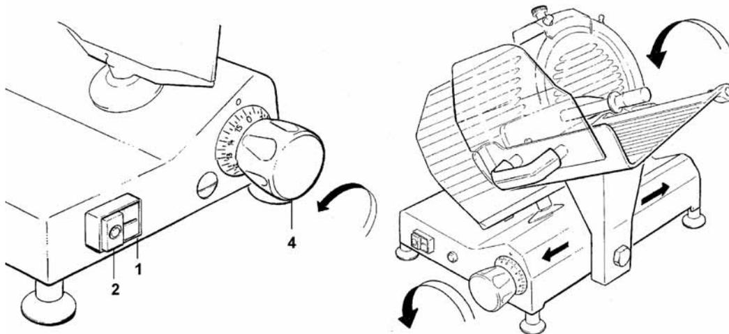
El espesor del corte se puede ajustar girando el puño (4), con escala graduada, en sentido anti-horario (contrario al de las manecillas del reloj).
