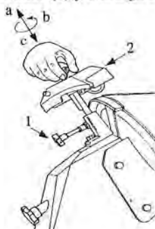
FIG. nº 15 - Extracción del afilador
