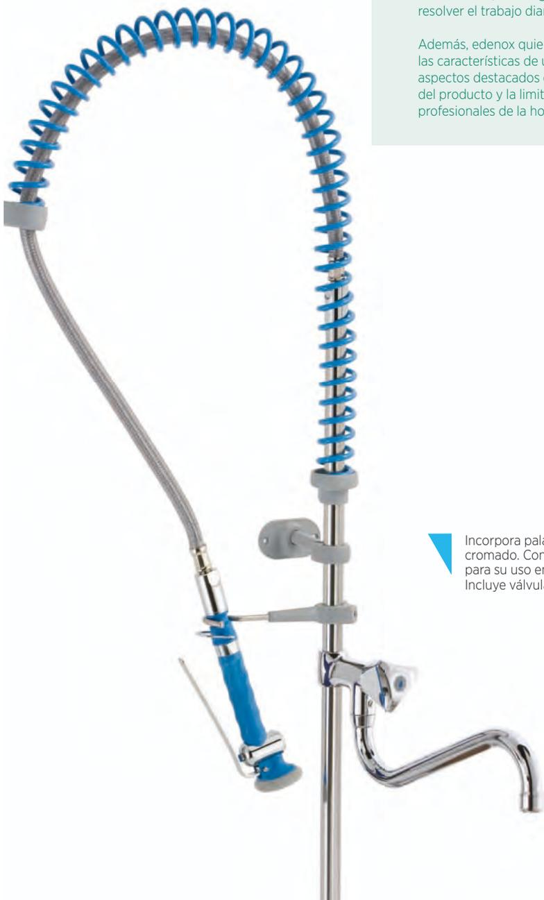
Muelle de acero con recubrimiento externo de pintura epoxi azul, mantiene sus características de anticorrosión y estabilidad en el tiempo. Terminales para el muelle en plástico conforme a normas. Soporte de pared de nylon con fibra de vidrio y latón.
