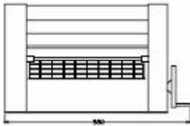
Laminadora manual, cilindros diámetro 60 mm, anchura de trabajo 400 mm, grosor de 0,1 a 27 mm. Tablas desmontables en acero inoxidable
