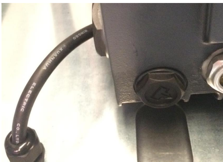
Ilustración 5. Quitar el tapón de vaciado del aceite
