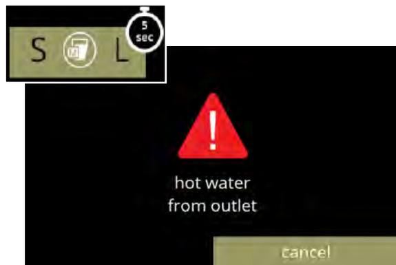
Al pulsar S M L en la pantalla de selección de bebidas durante 5 segundos, se activa inmediatamente el aclarado rápido con 90 ml (agua caliente) por sistema de mezclado.
