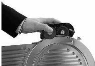
Fig. 5: Afilado de la cuchilla
