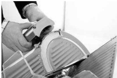
Fig. 3: Retirar el afilador
