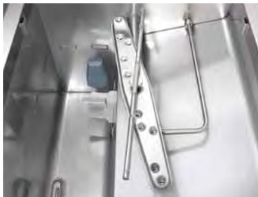
Brazos de acero inox que garantizan resultados brillantes y duraderos. Su filtro en acero inox proporciona una filtración eficiente de agua y una protección de la bomba ya que no se desgasta por el agua caliente y el detergente.
