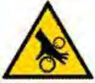
ADVERTENCIA: Durante el trabajo, está absolutamente prohibido retirar los resguardos de seguridad, debido a la presencia de piezas móviles que pueden provocar el aplastamiento de manos.
