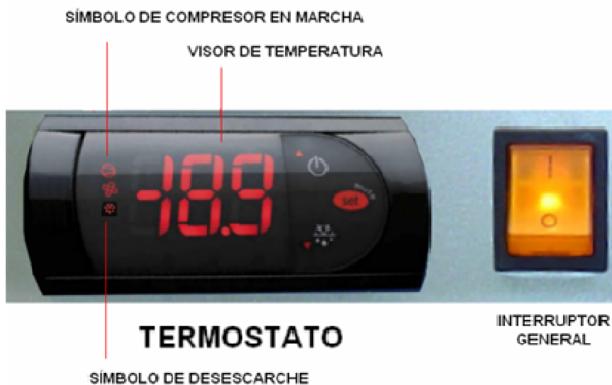
Cuadro de mando con interruptor y termostato
