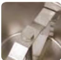
**Agitador com raspagem da lâmina em polietileno (PE) de longa duração. Todas as peças em contato com a mistura de creme ou gelo são de aço inoxidável e materiais atóxicos, de fácil acesso e removível para limpeza.**
