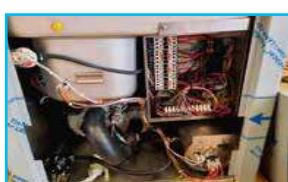
2 Bombas de lavado: 1HP independientes para brazo superior e inferior, máximo rendimiento y fácil accesibilidad.
