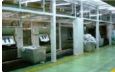
Este conceito separa os lados de carga e descarga, assegurando higiene ideal e evita o contato entre o limpo e desinfetado com roupas contaminadas.
