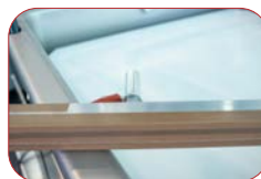
Barra de soldadura extraíble para facilitar limpieza.
