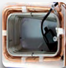
Sistema refrigeración banco de hielo.
