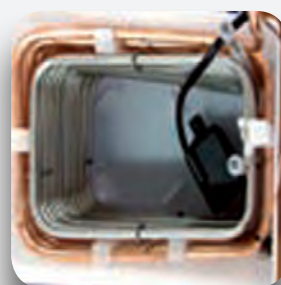
Sistema refrigeración banco de hielo.
