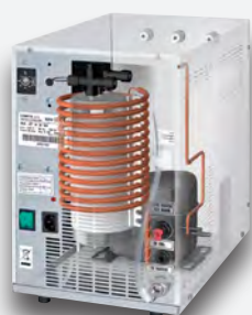
Sistema refrigeración banco de hielo.
