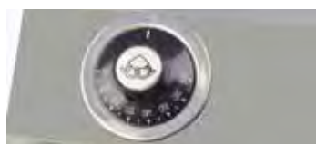
Termostato trabajo: EGO 190°C. Termostato seguridad: 210°C.
