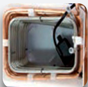
Sistema refrigeración banco de hielo.
