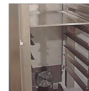
Ventiladores interiores para asegurar una distribución uniforme del aire frío.
